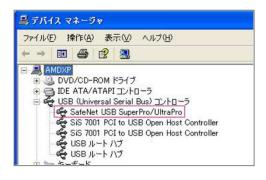
再起動後USB ハードキードングルを装着し、 コントロールパネルから「デバイスマネージャ」 を開いて「USB(Universal Serial Bus)コント ローラ」に次の表示が現れることを確認します
